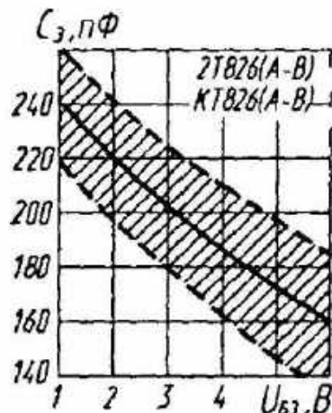
Зона возможных положений зависимости емкости эмиттерного перехода от напряжения база—эмиттер
