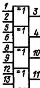
Условное графическое обозначение К564ЛП2
